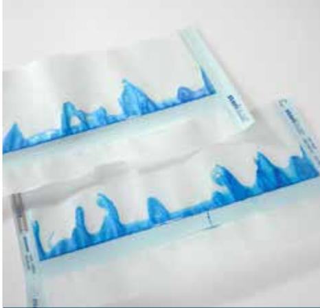
Test d'étanchéité de la soudure en application
