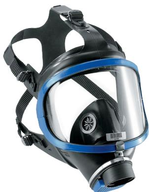
Efficace et peu onéreux, le **Dräger X-plore® 6300** est le masque intégral conçu pour les utilisateurs qui ne souhaitent pas faire de compromis sur le confort ni sur la qualité, tout en bénéficiant d'une solution économique. Raccord fileté Rd40 standard conforme à la norme EN 148-1, pouvant donc s'utiliser avec tous types de filtres avec raccord fileté Rd40 standard. Corps de masque en élastomère EPDM, écran facial en PMMA.
